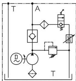
此液动力单元由高压齿轮泵、交流电机、液压阀、油箱等零部件有机结合为一体。为双柱汽车举升机提供升降功能，节流阀控制下降，可调节下降速度。
